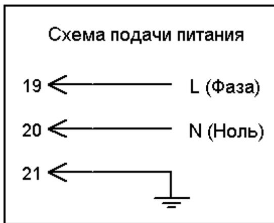
Мы рекомендуем поставить внешний автомат или предохранитель на ток до 3А в разрыв фазы, питающей это
