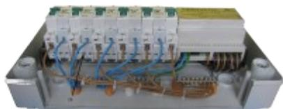
Между нулевой шиной и S6 контактора подключаем коммутируемую нагрузку.
