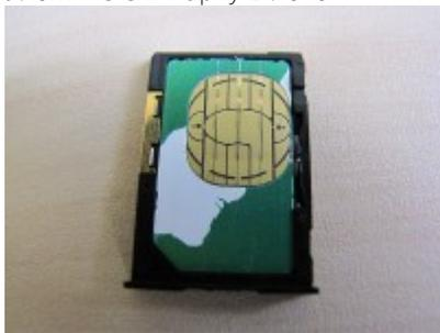
Вставьте лоток с симкартой в симхолдер , задвиньте его до упора в устройство.
