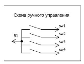
Вместо выключателей с фиксацией вы можете подключить любые датчики на замыкание-размыкание и получать SMS при их срабатывании, что превращает устройство управления нагрузкой в простейшую систему сигнализации, собранную своими руками.
